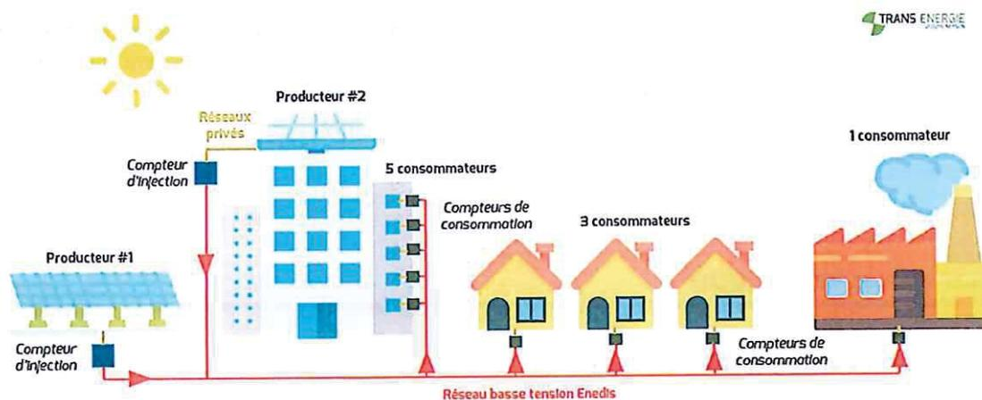
Figure 1 : Exemple de schéma d'autoconsommation collective, Source : Trans Energie
